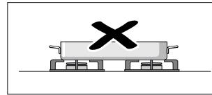
Niedopuszczalne jest podgrzewanie naczyn (np. brytfanny, patelni lub kamiennych płyt do grillowania) jednocześnie przez więcej niż jeden palnik. Powstająca w ten sposób kumulacja ciepła może uszkodzić urządzenie.
