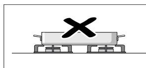
Pişirme kaplarını (örneğin kızartma kabı, tava, grill taşı) kesinlikle birden fazla brülörle ısıtmayın. Oluşan ısı yükseltmesi cihazda hasarlara yol açar.
