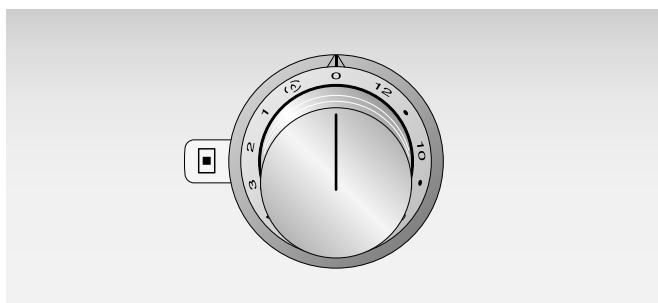
Značky u ovládacího knoflíku ukazují nastavení stupně vaření 1 až 12 nebo stupně mírného povaření (◊).
